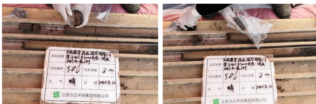
图 4.1-2 半挥发性有机物及重金属现场采样照片
